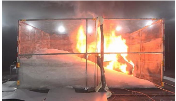
고정식 Foam 소화장치 시험 <Source : IMO SSE 9/INF.4>
